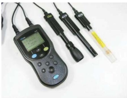
Figura 8. Medidor portátil de temperatura y oxígeno disuelto (HACH HQ40D).
