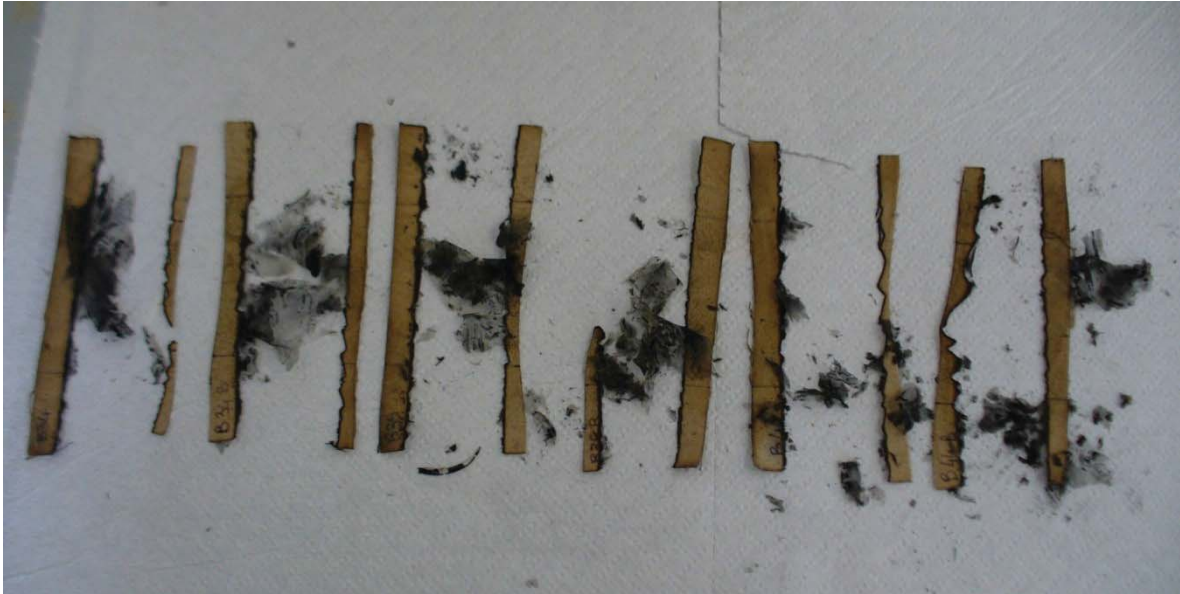
Figura 3.13: Residuos de tela de algodón después de las pruebas de Resistencia al fuego.
