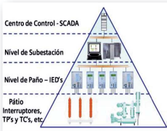
Fig. 1-1 Niveles de Automatización en una Subestación
