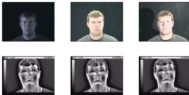
Figura 1-3: Arriba se observan imágenes en el espectro visible con distinto tipo de iluminación, mientras que abajo se observan las imágenes térmicas con la misma condición [19].
