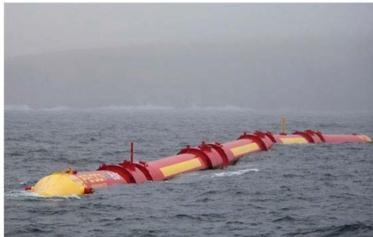
Figura 2-5 Pelamis P2, UK. Potencia nominal de 0,75 MW [25].
