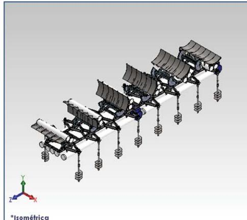
Figura 2-26 Modelo 3D del Dispositivo Wilefko de 100 kW de potencia.
