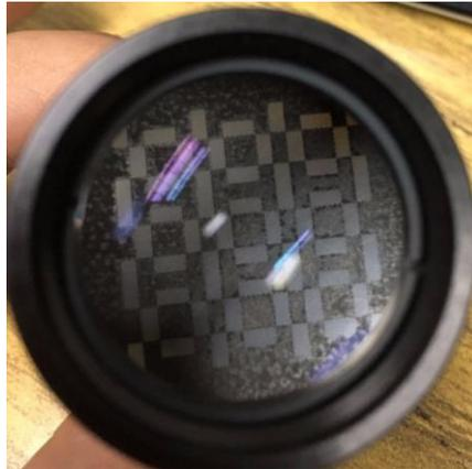
Figura 3-19: Ejemplo de filtro dentro del lente.
