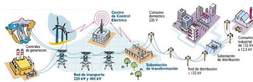
Figura 1-1: Sistema eléctrico de potencia [5]
