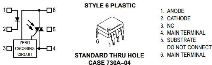
Figura 5-4: Optoacoplador MOC3041 con detector de cruce por cero integrado [19].
