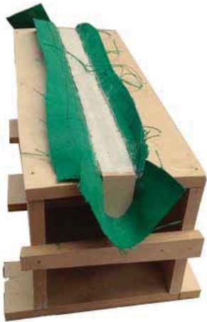
Foto: moldaje en su estructura de soporte
