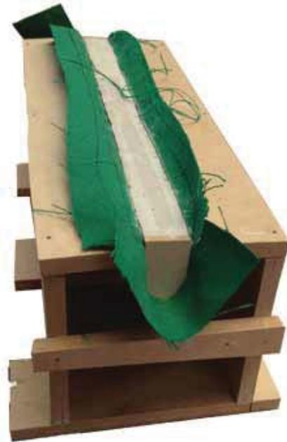
foto: estructura de soporte para el moldaje
