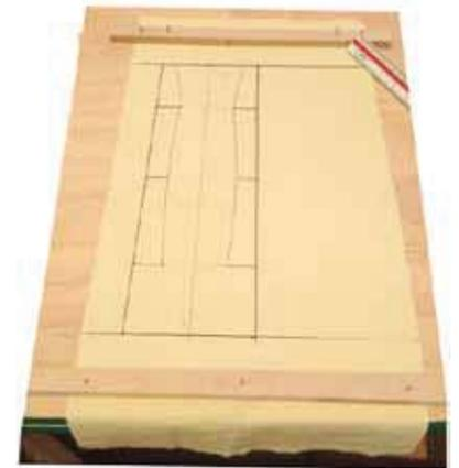
imagen: dibujo planimetrico de las medidas de la tela para construir la viga, luego se dibuja directamente en la tela.
