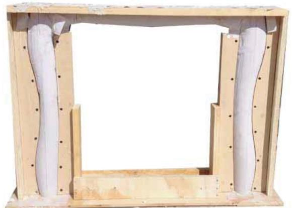
foto: estructura de soporte para el moldaje luego de ser llenada con el yeso
