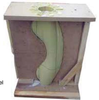
Foto: Estructura de soporte para el llenado con yeso
