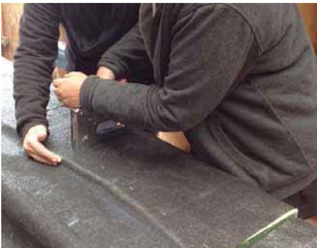
foto: engrapado para reforzar la unión de la tela con las matrices
