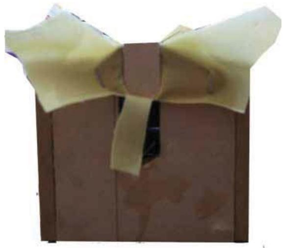
foto: estructura de soporte para el moldaje muestra como la tela se tensa en los extremos para evitar marcas y arrugas.
