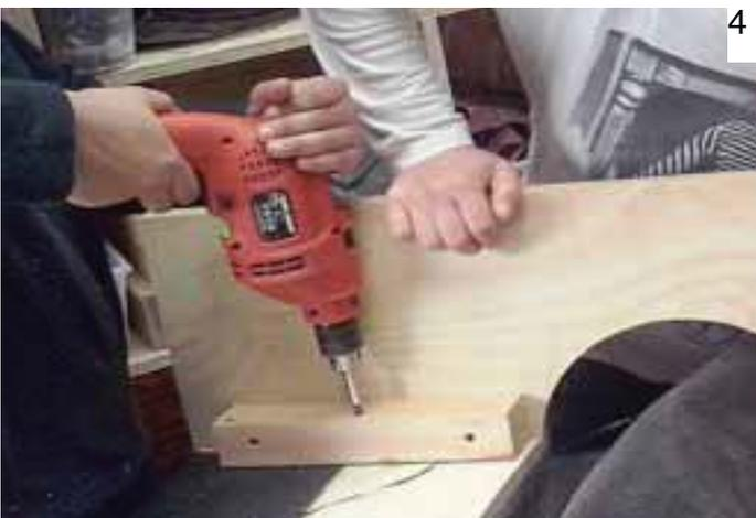
Foto: unión entre brocal y matrices con tornillos de 3"
