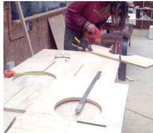
Foto: corte de los brocales por su eje longitudinal
