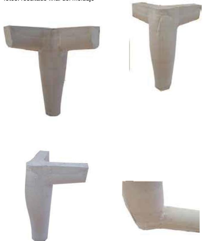
La matriz de unión viga - columna se inclina para evitar que la columna choque y pierda su forma
