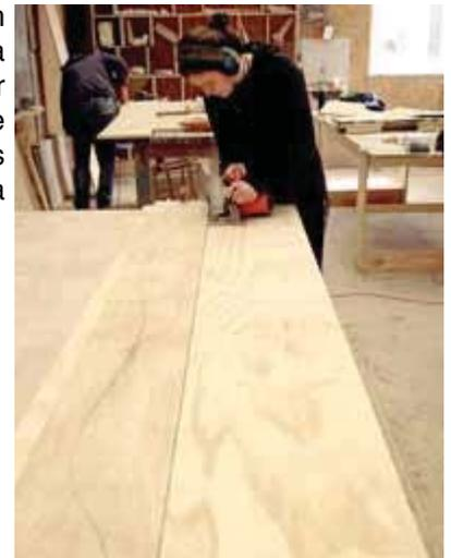
Imágen: foto del proceso de dimensionado de la plancha de terciado
