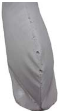
Resultado Modelo nº 5 en Yeso escala 1:5. Arrugas en extremo de zona de elemento horizontal.
