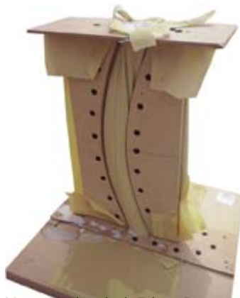
Maqueta - Llenado de Tela en Estructura Rígida de Soporte
