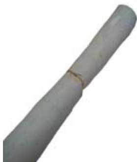
Quiebre en un extremo del Modelo nº 10 en Yeso escala 1:10
