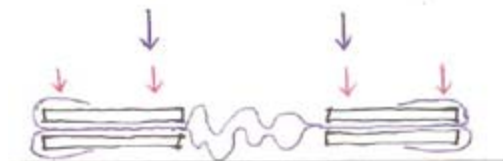
5) - 9) Esquema. Por ambos lados se unen las matrices. Flechas rojas: tornillos. Flechas azules: pernos.
