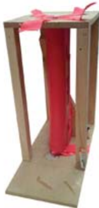
Maqueta - Llenado de Tela en Estructura Rígida de Soporte
