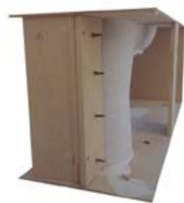
Maqueta - Llenado de Tela en Estructura Rígida de Soporte
