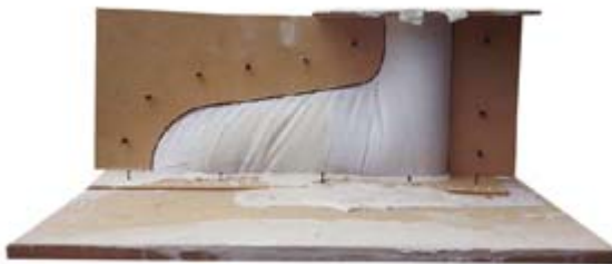
Maqueta - Llenado de Tela en Estructura Rígida de Soporte
