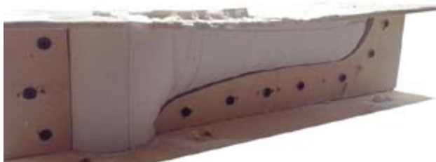
Maqueta - Llenado de Tela en Estructura Rígida de Soporte
