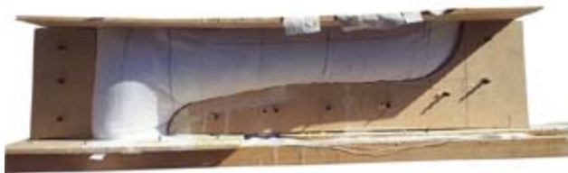
Maqueta - Llenado de Tela en Estructura Rígida de Soporte
