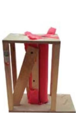
Maqueta - Llenado de Tela en Estructura Rígida de Soporte
