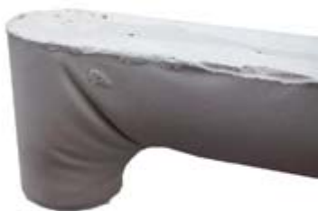
Resultado Modelo nº 6 en Yeso escala 1:5. Arruga en zona de unión entre columna y banca
