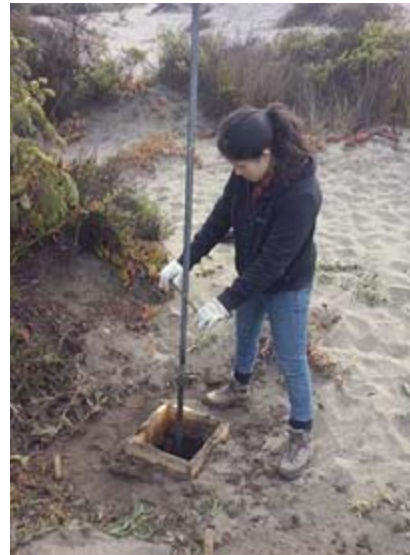
7) Pala de Rotación. Teniendo el punto del centro, a partir de las lienzas entre las 4 pequeñas estacas, se colocó el brocal que permitió que la arena no se desprendiera hacia el interior de la excavación. Con un fierro, que atravesaba el mango de la pala por un orificio, se logró dar la rotación de la pala y retirar la arena.
