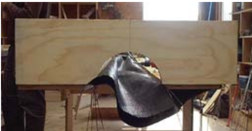
8) Se deja la tela -zona del flequillo- pasada por el orificio del brocal.
