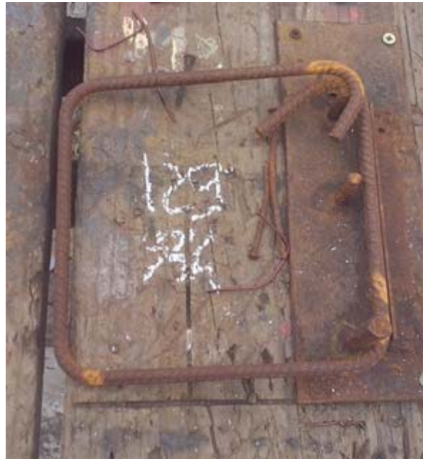
4) Estribo manufacturado en la machina. "Cachos" en la esquina superior derecha: terminación del estribo.
