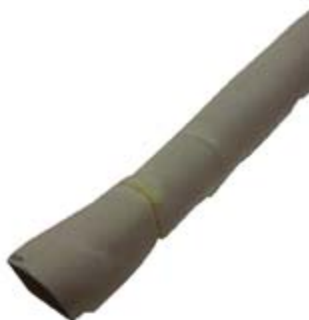
Quiebre en un extremo del Modelo nº 9 en Yeso escala 1:10
