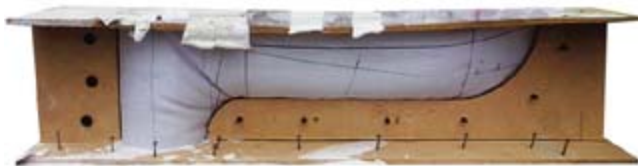
Maqueta - Llenado de Tela en Estructura Rígida de Soporte
