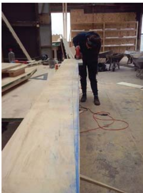
3) En el total de la tira de madera(s) de una pieza de una matriz, se dibujó la línea de la columna con un tubo de pvc (conduit), el cual permite la flexibilidad necesaria para obtener la curva del pilar.
