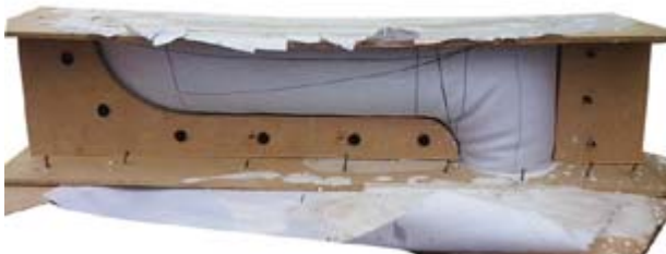
Maqueta - Llenado de Tela en Estructura Rígida de Soporte
