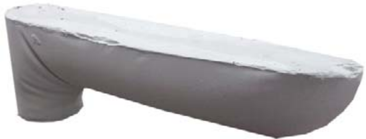
Resultado Modelo de elemento Banca, arrugas en zona de unión entre columna y viga
