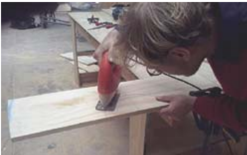
4) Corte de la mitad de la circunferencia con caladora.
