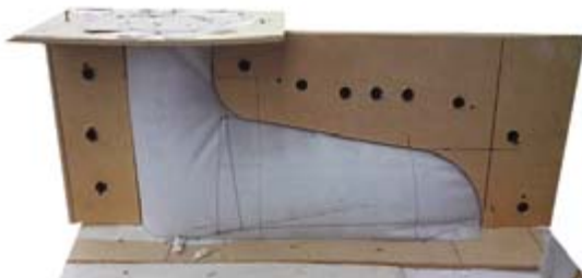
Maqueta - Llenado de Tela en Estructura Rígida de Soporte
