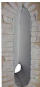
Maqueta - Llenado de Tela en Estructura Rígida de Soporte
