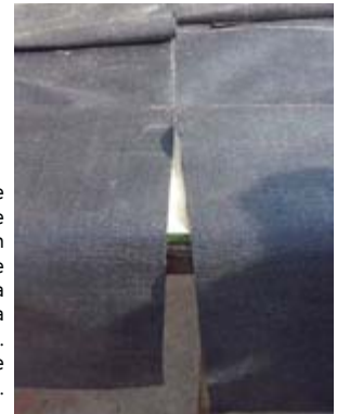
2) Corte de la Tela que permite un mejor calce entre la curva de la tela y la de la matriz. (No siempre son iguales).
