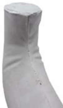
Resultado Modelo nº 5 en Yeso escala 1:5. Arrugas en zona de unión de columna con elemento horizontal
