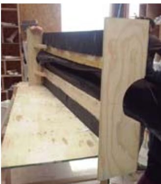
4) El moldaje flexible poseía 2 partes a partir del eje de las matrices, facilitando la faena de desmoldado, además de obtener las piezas intactas para volver a ocuparlas en otro moldaje.
