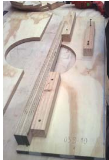
5) A cada pieza de un brocal se le añaden 2 trozos de listón de 2x2", los cuales permiten unir esta pieza a la matriz.
