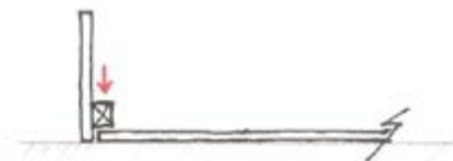
6) Esquema unión de brocal a matriz. Se unió con tornillos (flecha roja) desde los tacos que se añadieron anteriormente.
