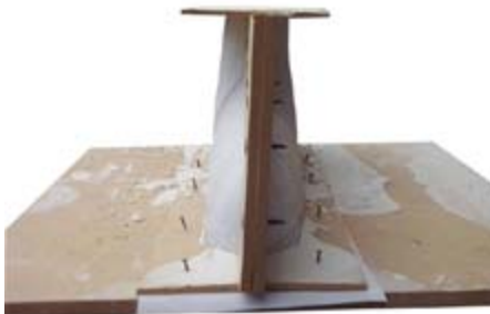
Maqueta - Llenado de Tela en Estructura Rígida de Soporte
