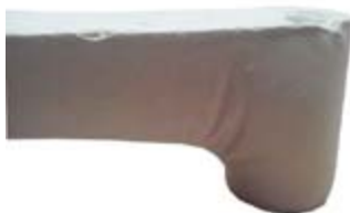
Resultado Modelo nº 9 en Yeso escala 1:5. Arrugas en zona de unión columna-voladizo
