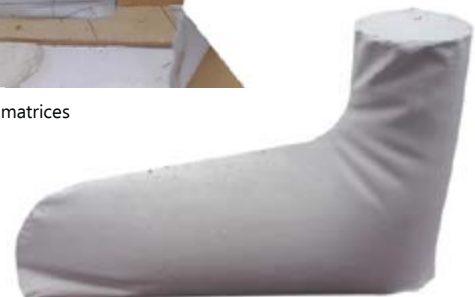
Modelo de elemento Asiento con arrugas en columna, zona de unión y en la punta
