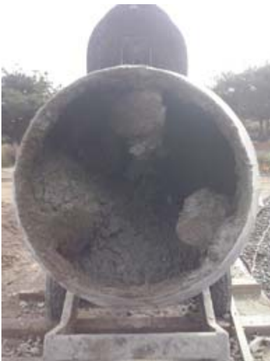
4) Betonera mezclando. La mezcla pasa a las carretillas -en este caso 1 betonera = 2 carretillas-.
