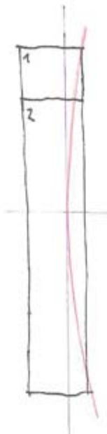
Esquema Tira de Matriz. Ejemplo de una matriz que posee 2 pedazos al tener más altura que 244 cm (medida de la placa). Con los 2 pedazos juntos se dibujó la curva con un conduit -tubo de pvc-.
