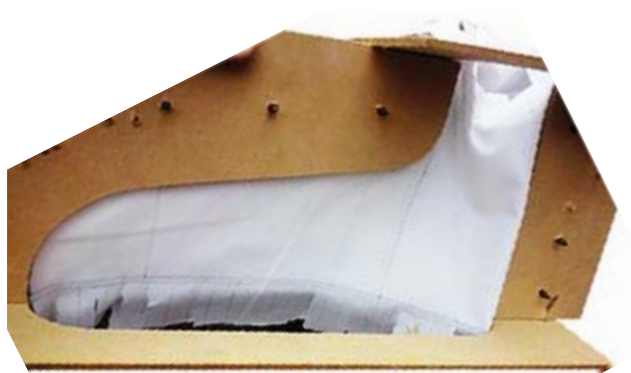
Maqueta - Tela que no alcanza a Pegarse al Brocal Inferior.
