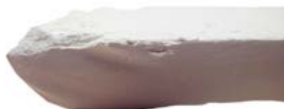
Resultado Modelo nº 9 en Yeso escala 1:5. Punta con irregularidades y arrugas
