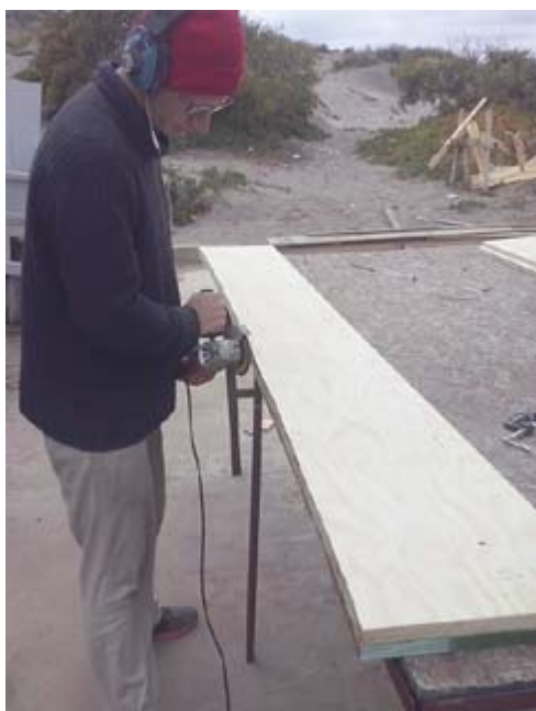
6) Teniendo el par de piezas de matrices hermanas cortadas, se procede a lijarlas en su nuevo lado curvo para obtener uniformidad en el nuevo borde.
