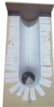
Maqueta - Llenado de Tela en Estructura Rígida de Soporte
