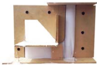
Maqueta Imagen Lateral - Llenado de Tela en Estructura Rígida de Soporte
