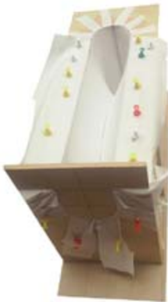
Maqueta - Llenado de Tela en Estructura Rígida de Soporte
