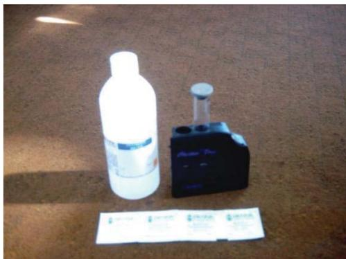
**Figura 11:** Kit de medición ozono marca Hanna instruments, tipo de producto HI 38054.
