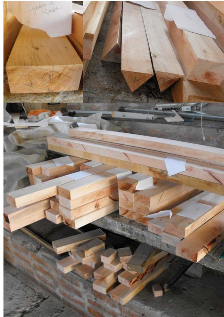
marcan con un distanciamiento de 2 milímetros para considerar el paso de la hoja. En esta parte el trabajo tiene que ser considerablemente preciso ya que estas piezas no podrían pulir las fallas con tanta facilidad como con el resto a causa del ángulo que tienen que mantener. En la lógica de corte de la mayoría de las piezas siempre se cuida en dejar un sobrante que luego pulir con mayor tranquilidad y precisión.
