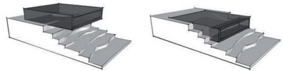
[310] LOS TRES DISTINTOS EDIFICIOS SE CONSTITUYEN DE MODO AZOCALADO O ELEVADO SEGÚN LA LÍNEA TOPOGRÁFICA DEL TERRENO EXISTENTE
