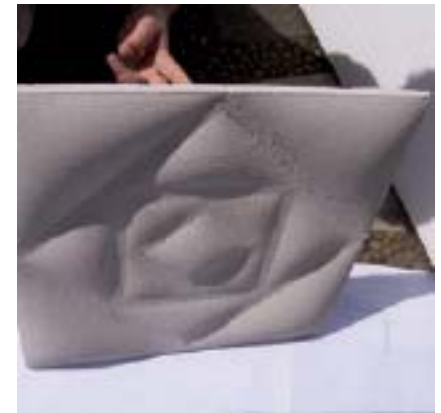
Prototipo de moldaje a pequeña escala, para estudiar la configuración diagonal de pequeñas losetas triangulares, que conforman una losa mayor cuadrada.
