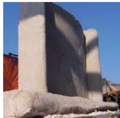
Construcción a media escala, de una sección de losa, con configuración de subdivisión ortogonal. (Loseta de gran tamaño, en conjunto con una viga y dos viguetas, con nudos ortogonales).
