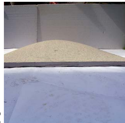
Prototipos de losa con moldaje flexible, a pequeña escala. Estudio de la tensión de las telas, para calcular una curvatura
