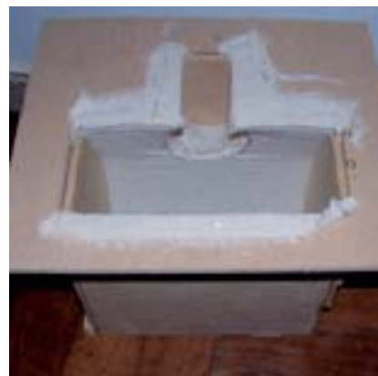
Prototipo de moldaje a pequeña escala, para el estudio de corte de telas y costuras en un nudo ortogonal, entre una viga y una vigueta, que sostendrían losetas entre sí.
