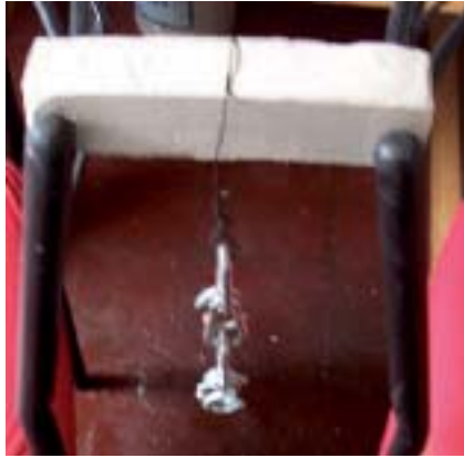
Pruebas resistencia y colapso, de las barras, con un aumento progresivo de las cargas.
