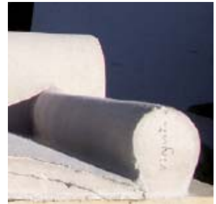
Construcción a pequeña escala de una sección de losa, con configuración de subdivisión ortogonal. (Loseta, en conjunto con una viga y dos viguetas, con nudos ortogonales).
