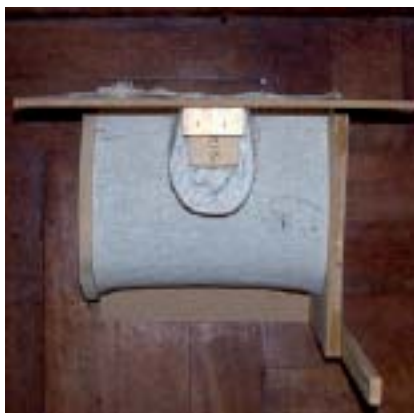
Prototipo de moldaje a pequeña escala, para el estudio de corte de telas y costuras en un nudo ortogonal, entre una viga y una vigueta, que sostendrían losetas entre sí.
