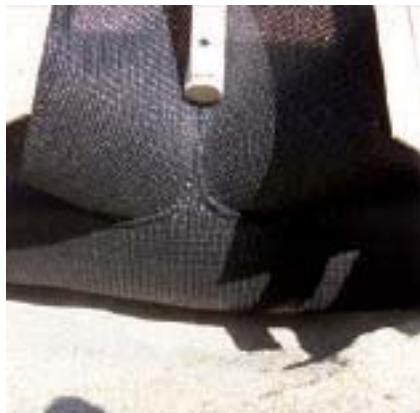
Prototipo de moldaje a pequeña escala, para el estudio de corte de telas y costuras en nodos diagonales, entre una viga y dos viguetas.
