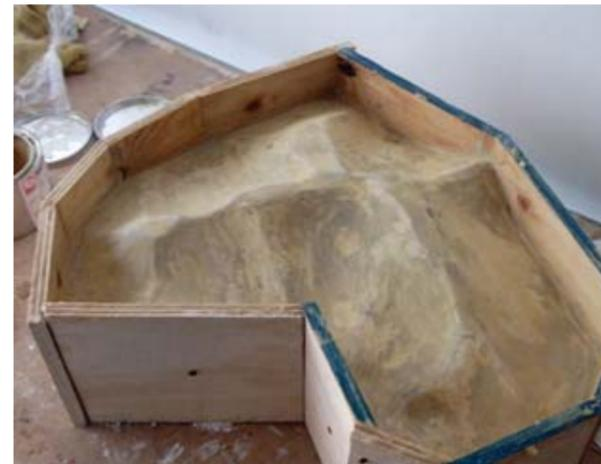
Pieza + encofrado + capa de fibra de vidrio con resina.
