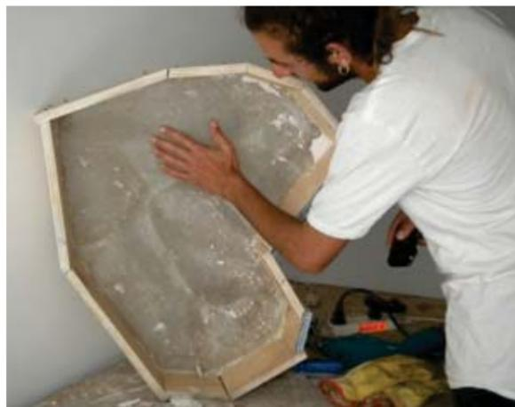
La capa de fibra de vidrio es lo suficiente resistente para no deformarse con hormigón
