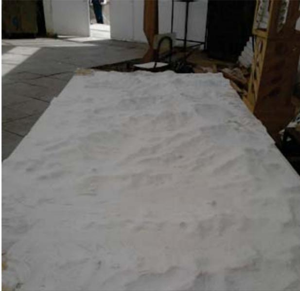
Se aplica pasta muro para tapar las curvas de nivel construidas por la router CNC, como primer paso a la unificación de la forma.
