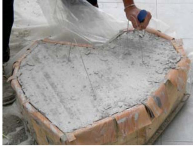
Desde los alambres de agarre se levanta la pieza para desmoldarla.
