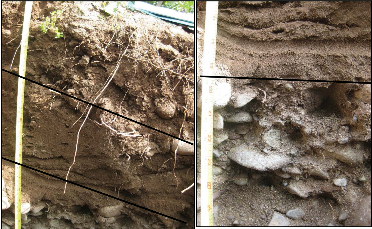
Figura 1. A. Perfil de suelo calicata sector 1, las líneas horizontales distinguen las estratas 2 y 3. 1. B. Línea horizontal marca la diferencia entre la estrata 3 y 4.
