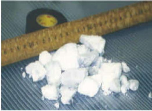
Figura 1.23: Capas masivas de hidratos puro obtenido en un testigo en Vancouver Island.
