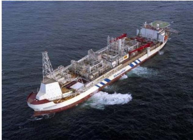
**Figura 2.28:** Sistema de producción flotantes (FPSO) [45].
