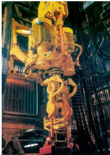
**Figura 2.33:** Un eslabón giratorio (Hydralift Power Swivel (HPS)).
