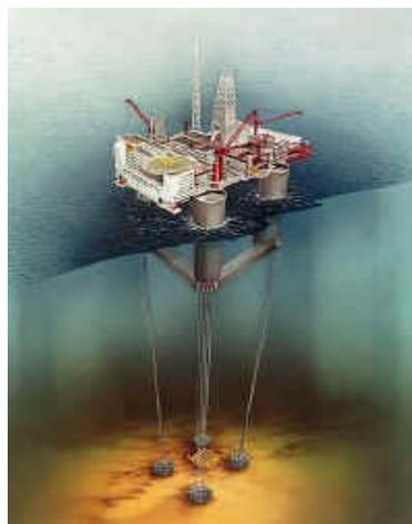
**Figura 2.29:** Sistema de plataformas de producción de patas en tensión [45].
