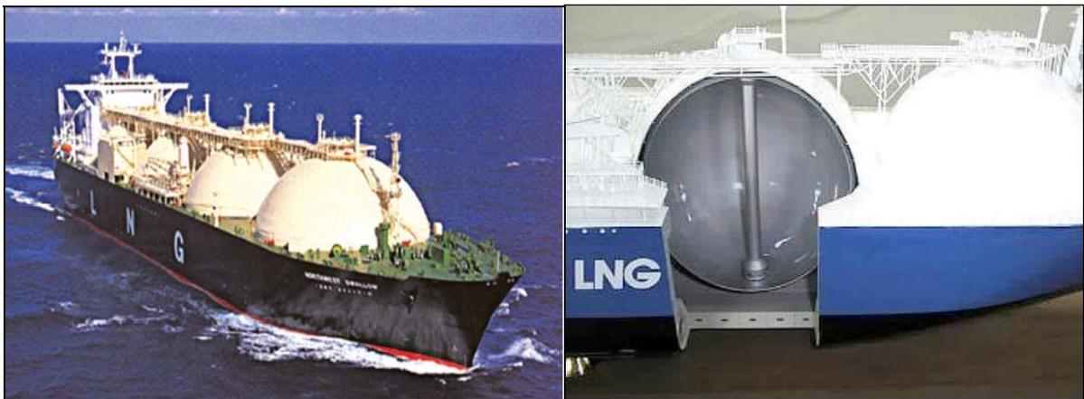
**Figura 2.50:** Naves cargueras con diseño de recipientes esféricos.
