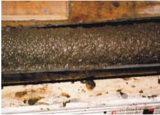
**Figura 1.21:** Hidratos de gas en granos diseminados en un testigo de Mallik (Canada)
