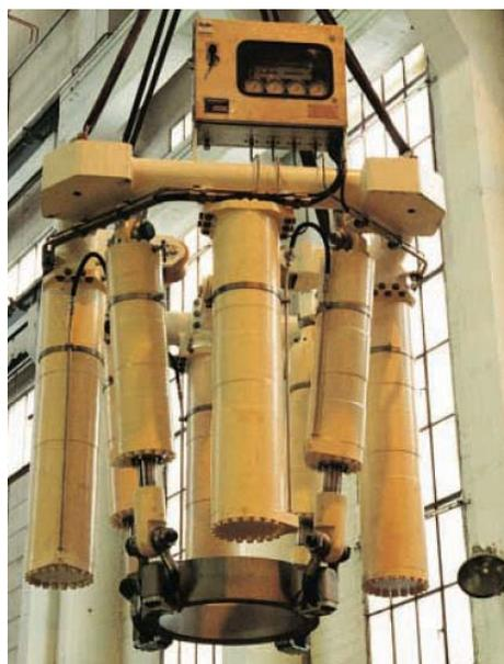
Figura 2.39: Sistema Tensor hidráulico del tubo de elevación (Hydralift Cia)
