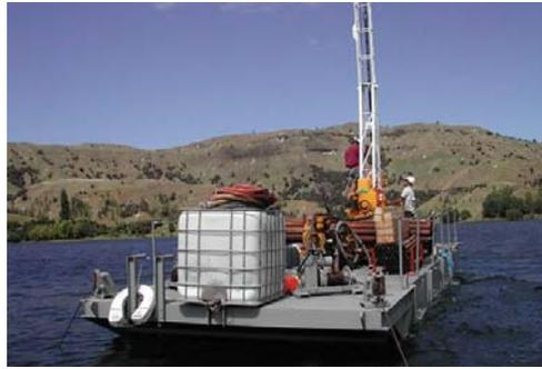
**Figura 2.23:** Barcaza de perforación (Drilling Barge) [41].
