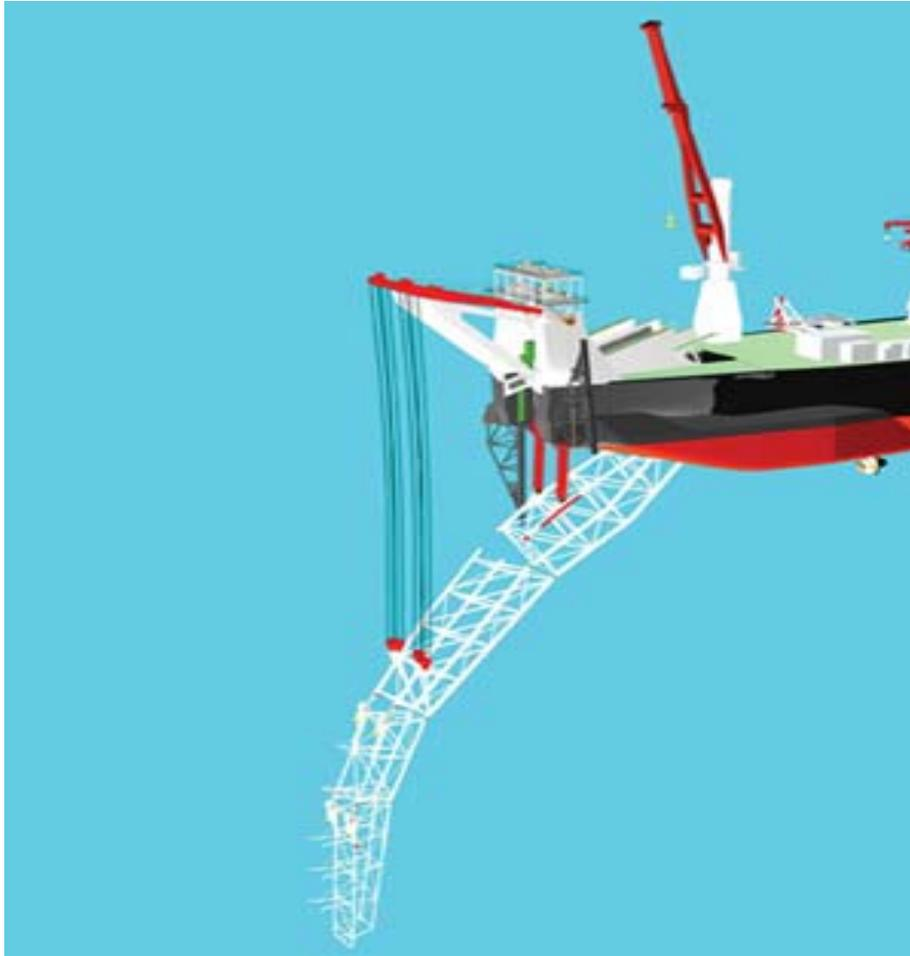
**Figura 2.44:** Embarcación para tender tuberías método “S-lay”.
