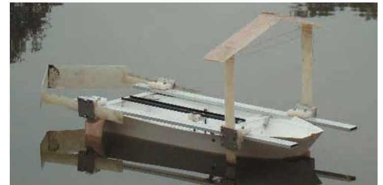
Modelo en prueba de arrastre, laguna Sausalito
