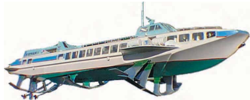
Vista inferior de sistema de Hidroala y propulsión en embarcación Holandesa.
