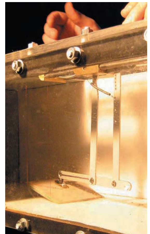
Prueba en seco del sistema con bielas
