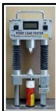
Figura 1 – Máquina para realizar test de carga puntual [Fuente: JKTech]
