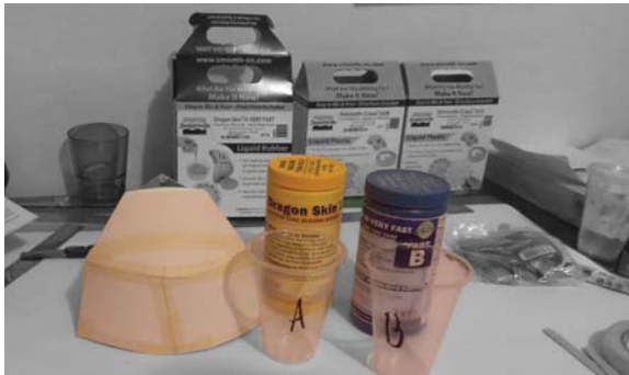
Molde de cartón que contiene a la pieza impresa (fijada); y los dos componentes del caucho para sacar la contra-forma de la pieza.
