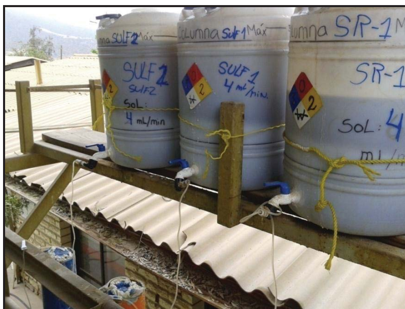
Figura 12. Bidones de riego de columnas
