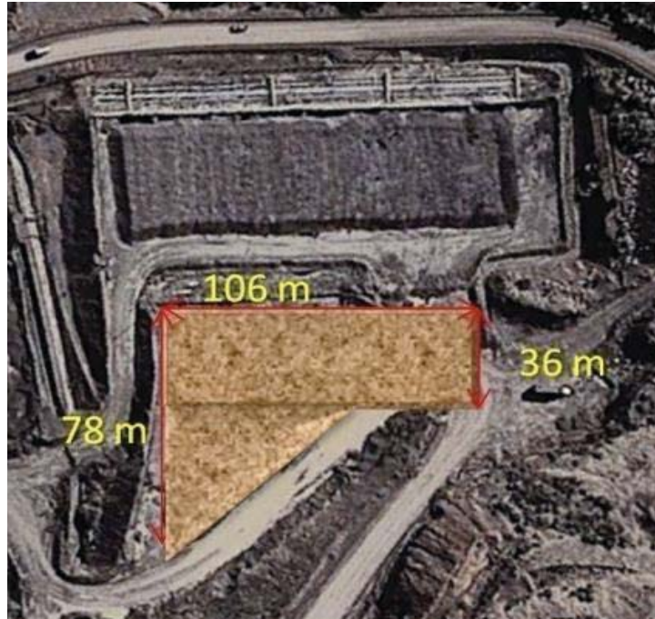
Figura 43. Proyección de superficie en ampliación de cancha 3
