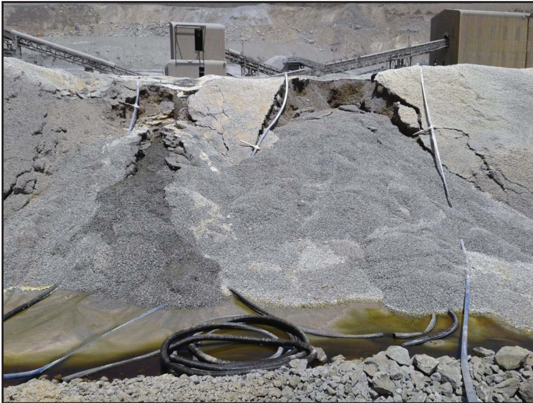
Figura 9. Deslizamiento de una pila de lixiviación por anegamiento superficial.
