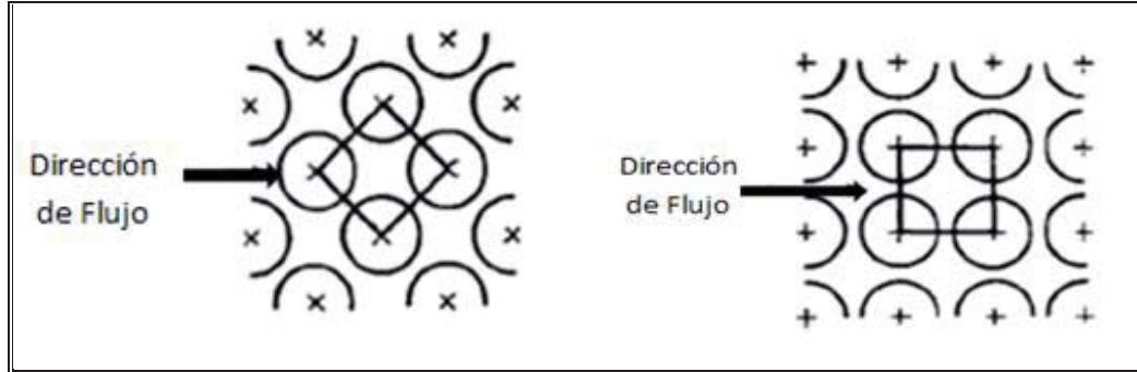
Figura N° 16: Disposición del haz de tubos arreglo Cuadrado
