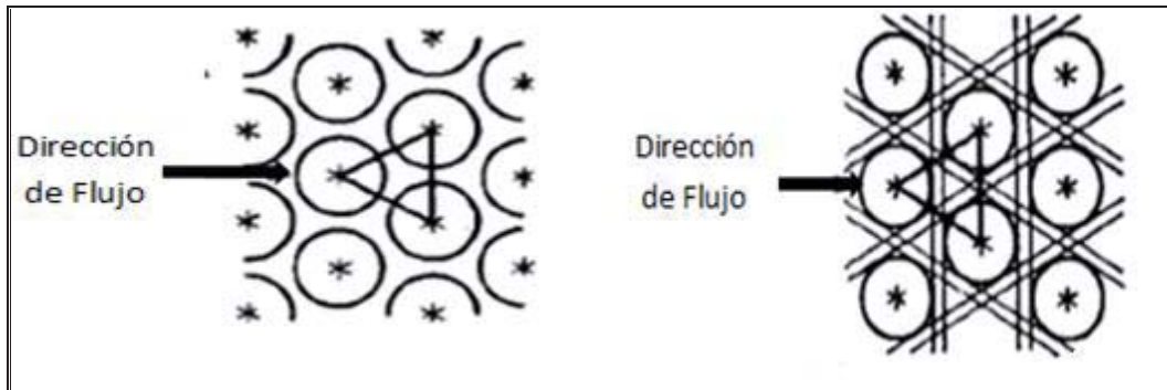
Figura N° 17: Disposición del haz de tubos arreglo Triangular
