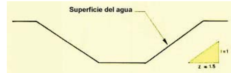
Fig. 65. Cálculo de la pendiente del talud.
