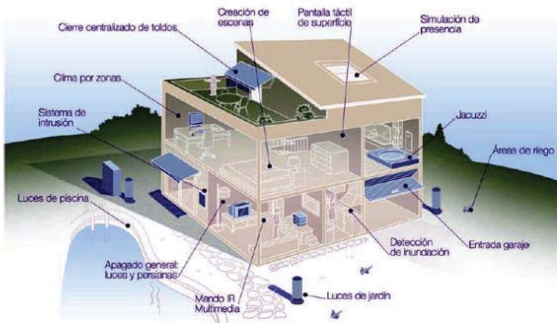
Ilustración 3.3 - Rango de operación de un sistema domótico clásico.
