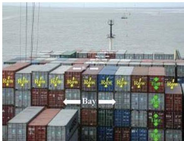
Figura 3.4 – Sistema BAROTI. Fuente: *containerhandbuch.de*
