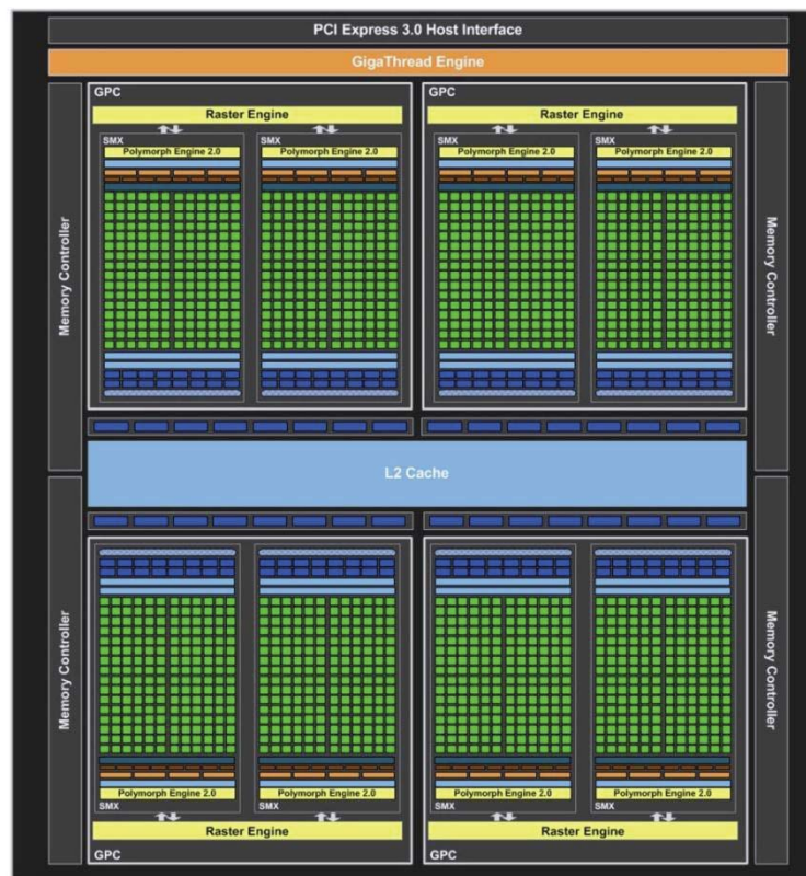
Figura 3.1 GPU Arquitectura Kepler
