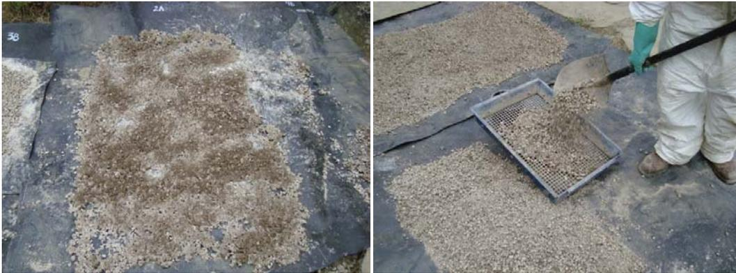
Figura 4.18: Secado y disgregación de ripios.
