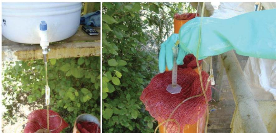
Figura 4.16: Control de tasa de riego.
