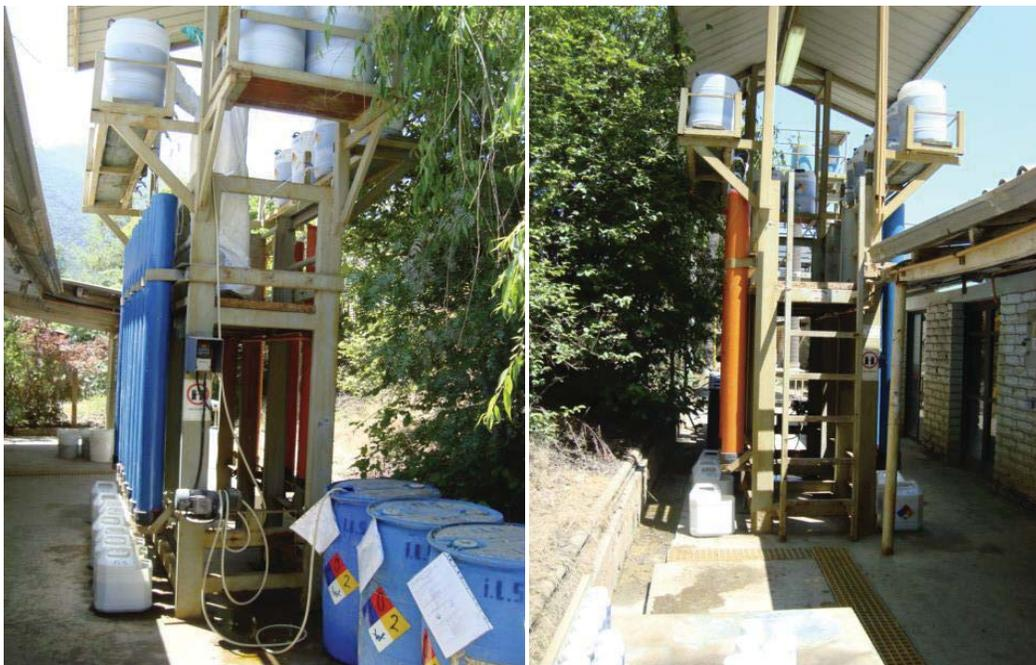
Figura 4.14: Instalación columnas de Lixiviación
