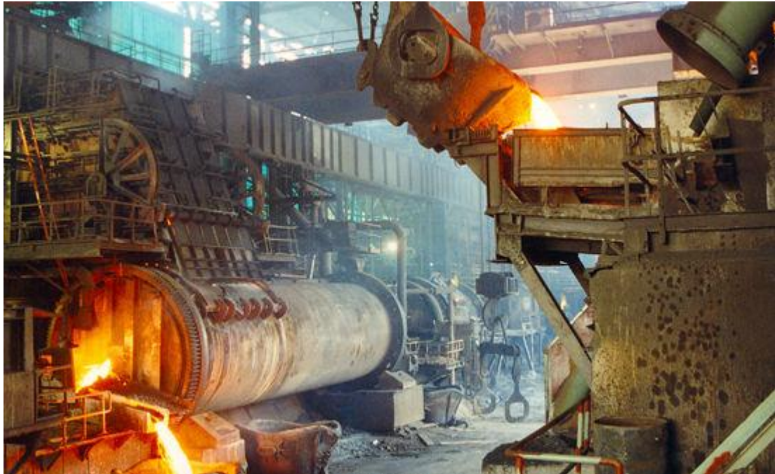
Figura 7. Alimentación de Escoria proveniente del CT al Horno Eléctrico (lado derecho).
