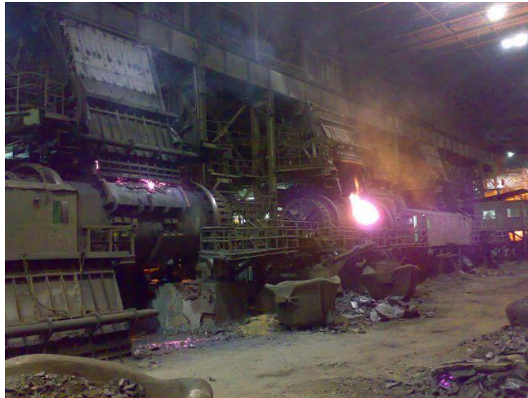
Figura 4. Dos CPS, uno soplando (lado izquierdo) y el otro en Calentamiento (lado Derecho).
