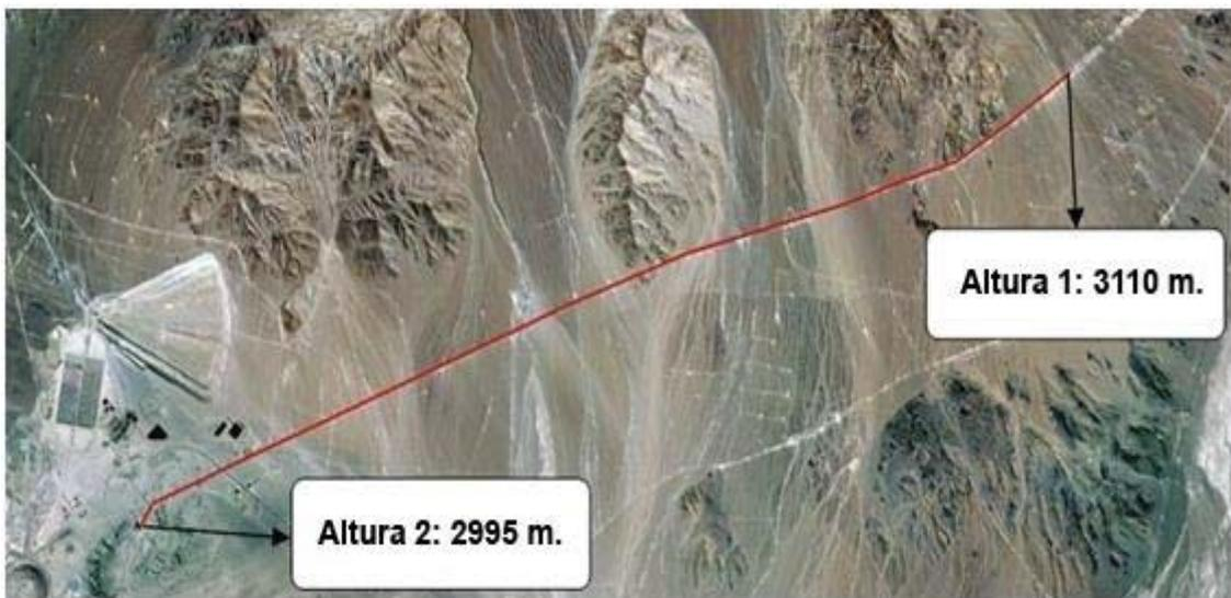
Figura 31: Estimación de la diferencia de altura para Aducción de San Pedro.
