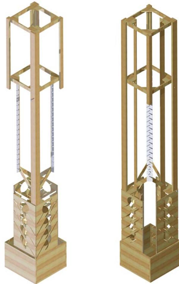
Hecho de Madera, la estructura parte con una base o "cajón" cuadrado del que se acoplan 2 listones en vértices contrarios que son unidos en una cuadrilla superior, dando así la forma de la columna.
