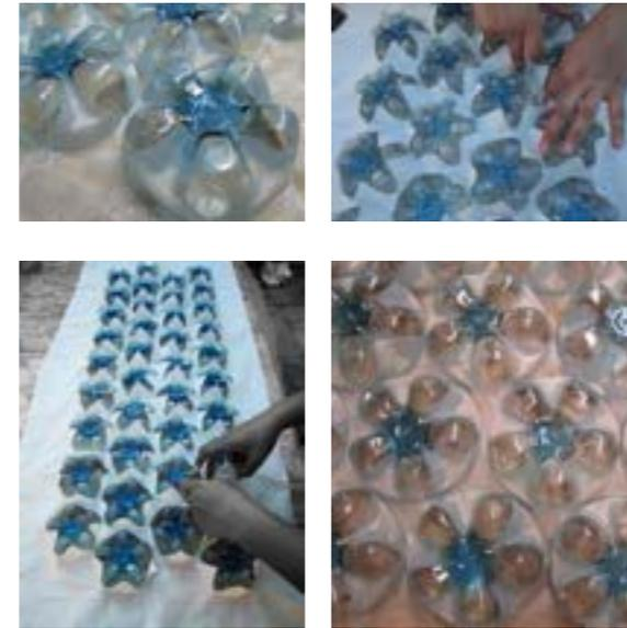
Tela cortada con las dimensiones del panel y donde una matriz hizo el corte de encaje donde posteriormente se ponen las bases de la botella, para luego aplicar resina y fijar a las bases de las botellas.
