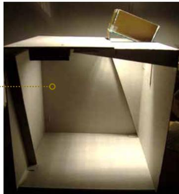
prueba de prisma con suma de 2 vidrios acanalado en la base.
