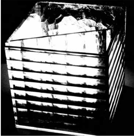
Cubo construido con dos caras acanaladas 3mm + una cara oceánica 3mm + un lado de espejo orientado hacia el interior.
