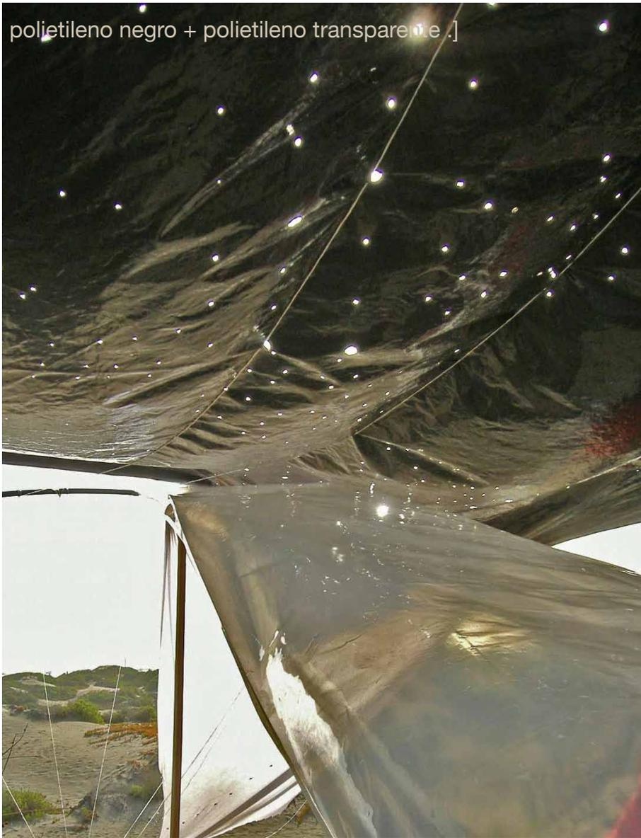
Continúan las pruebas en las dunas de Ritoque. Bajo el polietileno negro calado se tensa una doble capa de polietileno transparente sin intervención.
