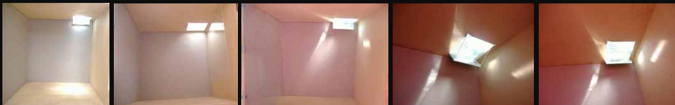
entrada de luz esquinada y dispersa / entrada tenue / entrada de triángulo reflectivo, produce un redireccionamiento de haces al cielo y muros adyacentes de la caja.
