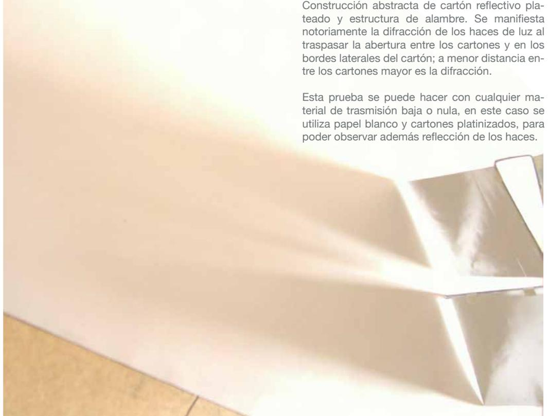
Construcción abstracta de cartón reflectivo platinado y estructura de alambre. Se manifiesta notoriamente la difracción de los haces de luz al traspasar la abertura entre los cartones y en los bordes laterales del cartón; a menor distancia entre los cartones mayor es la difracción.
