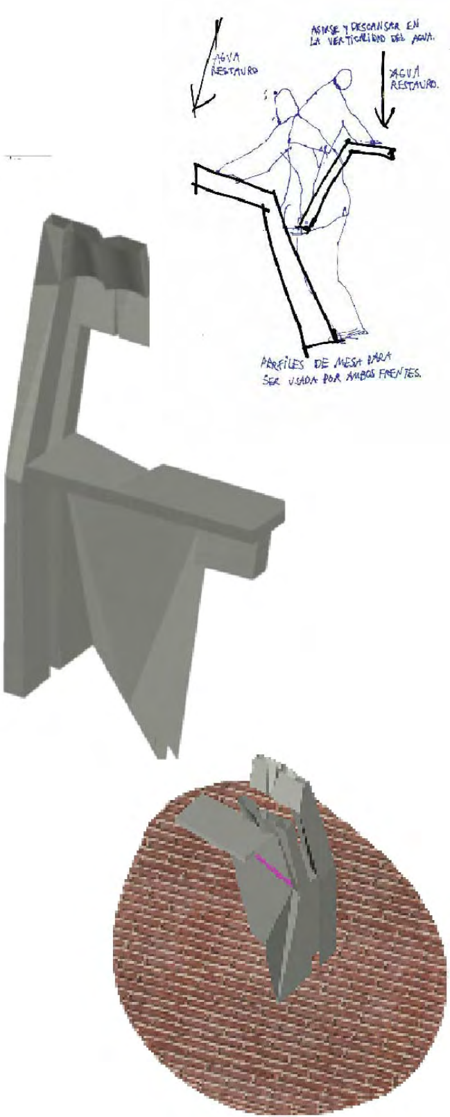
Fig.262 Esquerma generador de los perfiles de la mesa.Los extremos de ella se usan desde posiciones contrarias. El perfil acoge el desplomarse en ella.. Fig.263 Modelizado del bebedero en completitud. La mesa, las paletas, el zocalo y la vertical forman parte de este modulo. Fig.264 Modelizado del bebedero ubicado dentro del suelo de la demora. Este aparece con un suelo de ladrillo con la cantería orientada más no detallada..
