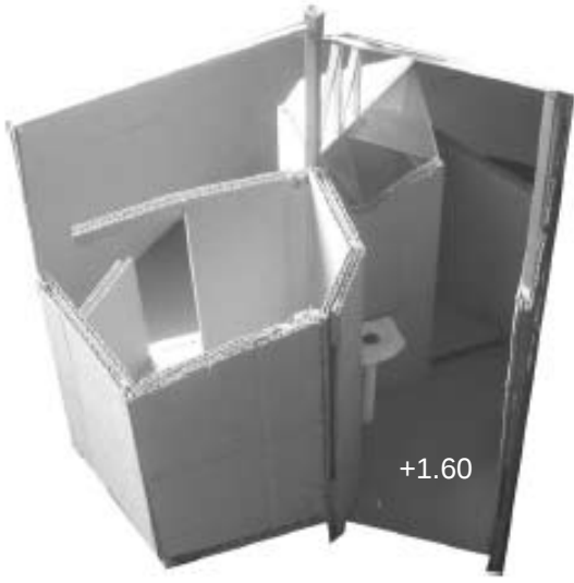
Fig.141 Planta de estudio que desarrolla la separación de los artefactossanitarios según su nivle de intimidad. Fig.142a,b Maquette que muestra la división del lavamanos del w.c. Esta nueva propuesta se estructura a través de una cruceta de ladrillo y algunos muros perimetrales.
