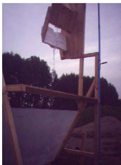
Fig.246a,b Modelo de paleta hecho de plumavit como experiencia sobre la conducción del agua a través de canales en una superficie.
