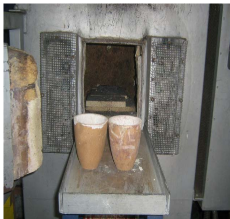
Queque Húmedo previo a proceso de Calcinación en Horno Harrop
