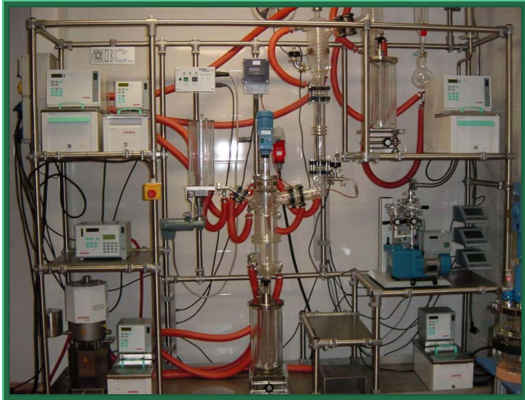
Figura 3.1. Destilador Molecular KDL5, utilizado en la destilación de solvente en la preparación de catalizador.
