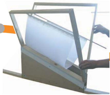
1. [ Prototipo marcos simétricos que al abrirse tensan la lámina y al estar cerrados como no se ejerce una torsión la lámina se mantiene estirada, sin arrugarse ]
