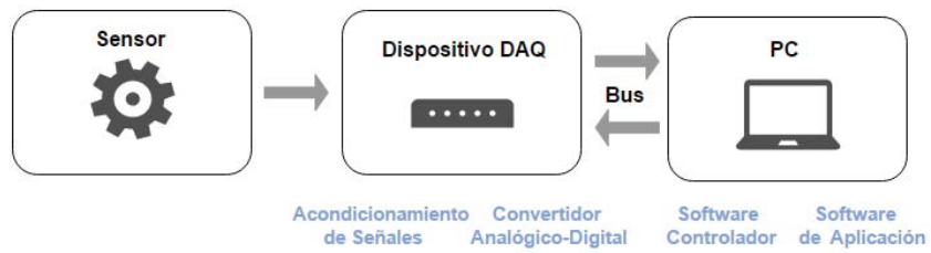
Figura 3-35: Diagrama básico de un sistema DAQ.
