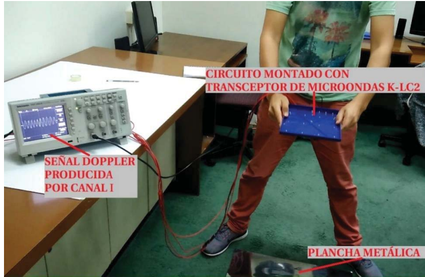
Figura 3-3: Prueba de reflexión realizada sobre una plancha metálica.
