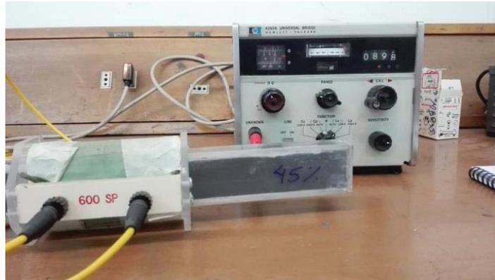
Figura 2-3 Medición de inductancia utilizando una bobina de 600 espiras, con núcleo de mineral seco cuya ley es del 45%
