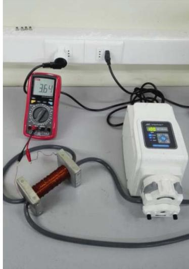
Figura 2-15 Mecanismo de flujo de pulpa a través del núcleo del solenoide
