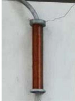
Figura 2-14 Bobina de 805 espiras con diámetro de circulación de pulpa de 7.9 [mm]
