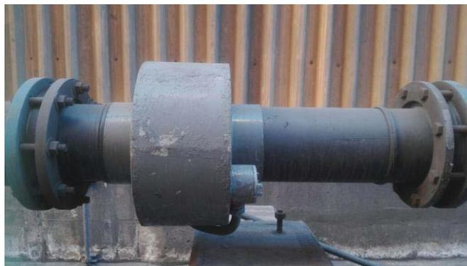
Figura 2-2 Equipo desfloculador instalado en planta Magnetita (fuente: David Valdés, Instrumentista II en planta Magnetita)
