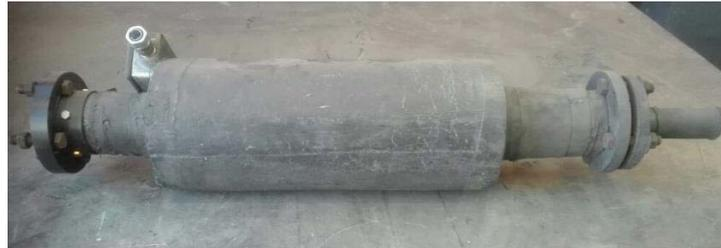
Figura 2-7 Magnetómetro utilizado en la planta (fuente: David Valdés, Instrumentista II en planta Magnetita)
