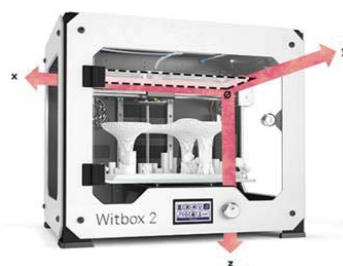
Figura 2-6: Impresora 3D con sistema de movimiento CoreXY [14].
