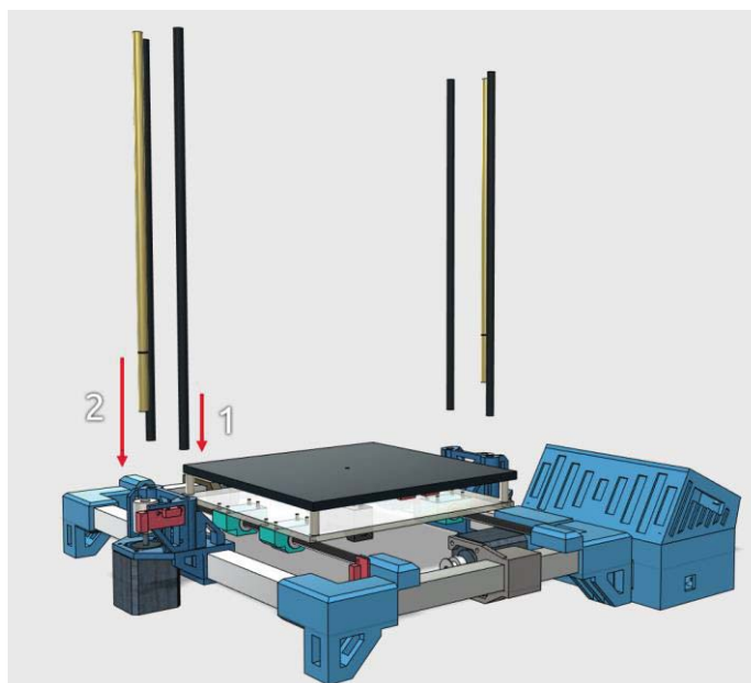
Figura A-24: Union de barras a eje Y
