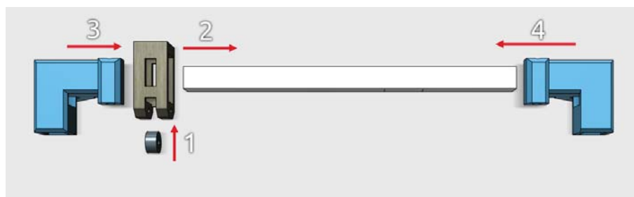
Figura A-14 : Proceso de union eje superior Y.
