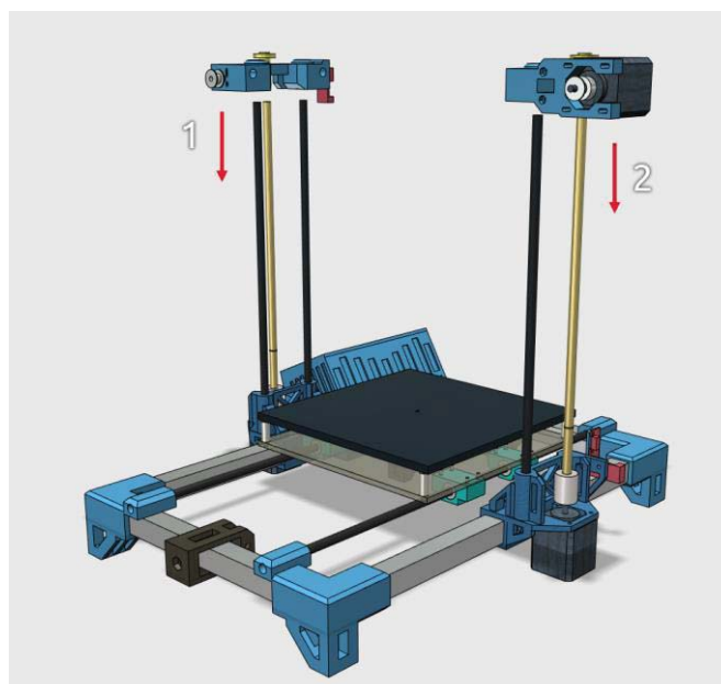
Figura A-27:Unión Eje X a eje Z
