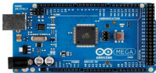
Figura 3-1:Placa Arduino Mega R3 2650 [17].
