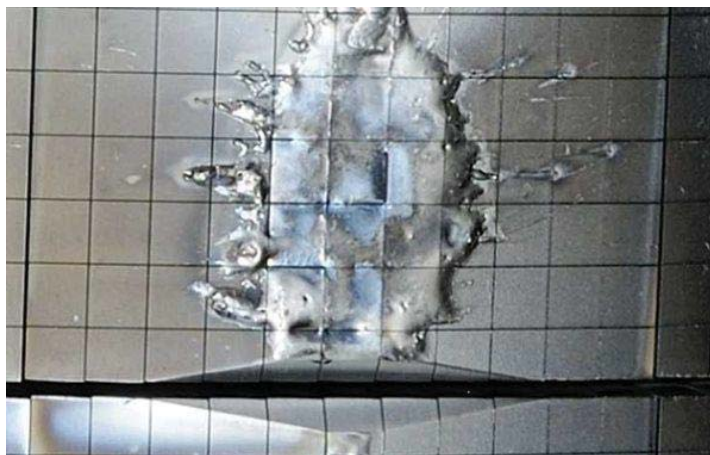
Figura 1-2. Daño provocado por disrupción
