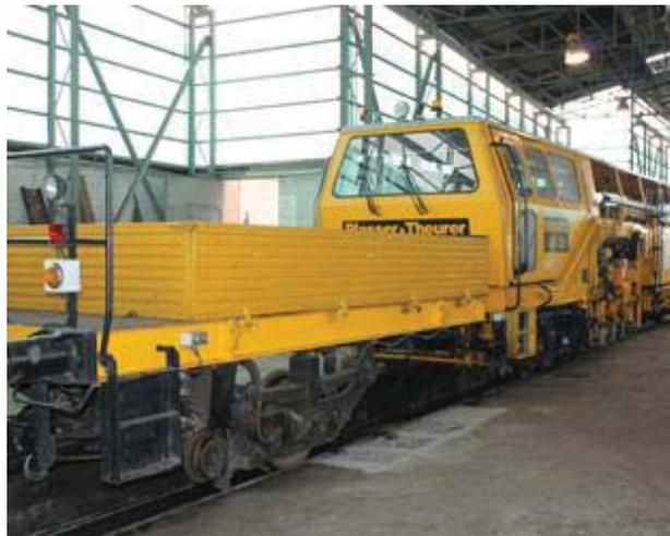
Figura 1-6: Equipo de Tracción para Labores de Mantenimiento [1].
