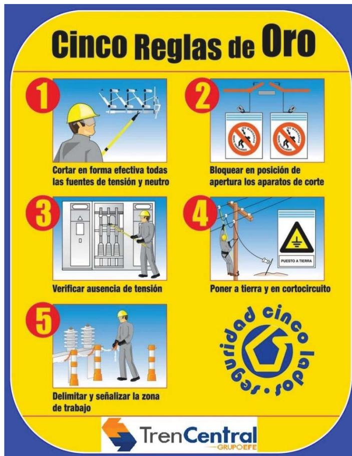
Figura 5.1: Mención y recordatorio de las 5 reglas de oro ante trabajos eléctricos. (Imagen Propia).
