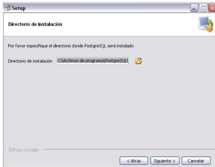
Ilustración A.7 – Selección de directorio de instalación
