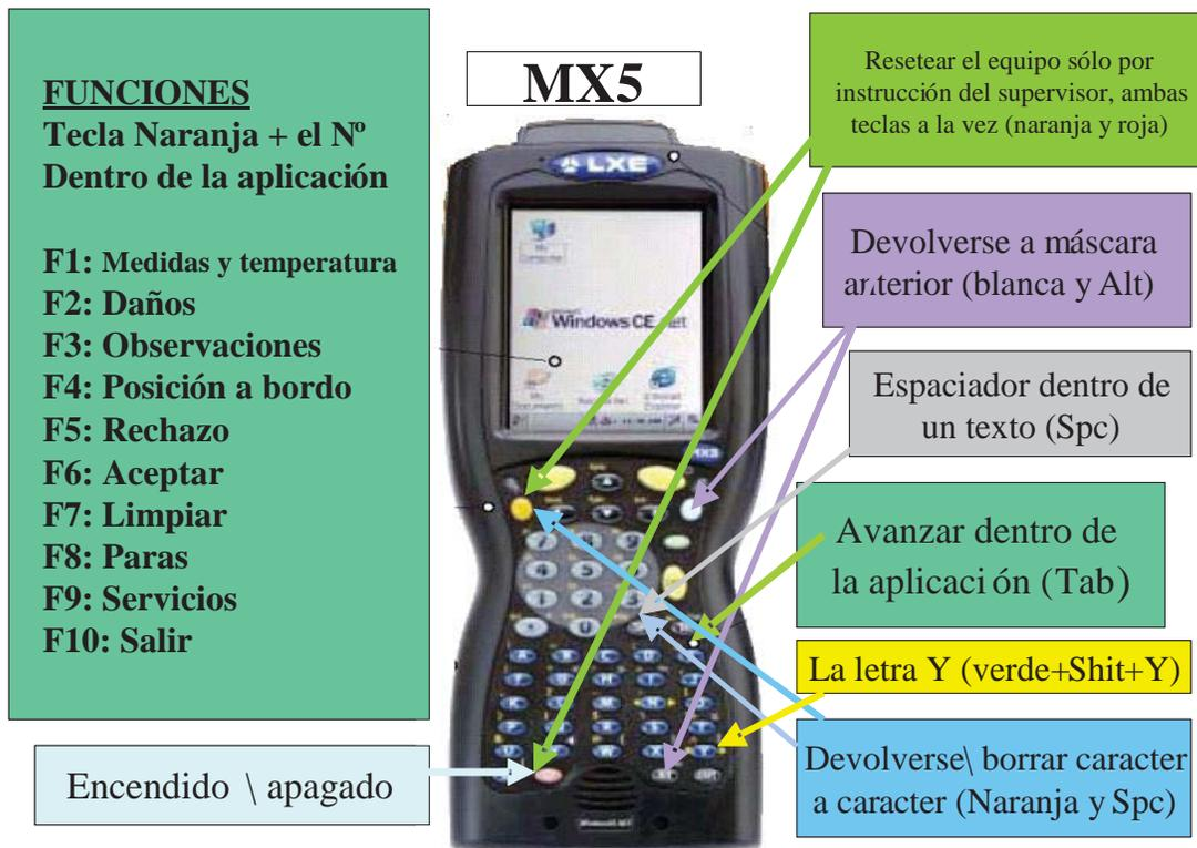
**Figura 11: Dispositivo portátil MX5**
