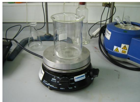
**Figura B-11. Agitador calefactor.**
