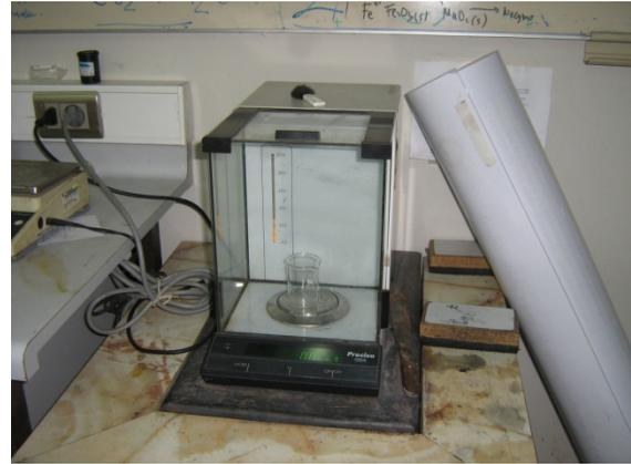
**Figura B-8. Balanza analítica.**
