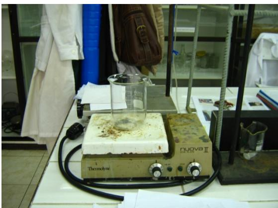
**Figura B-11. Agitador calefactor.**
