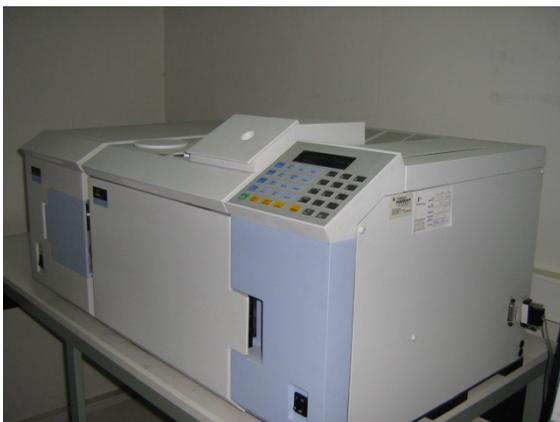
**Figura B-6. Cromatógrafo de gases.**
