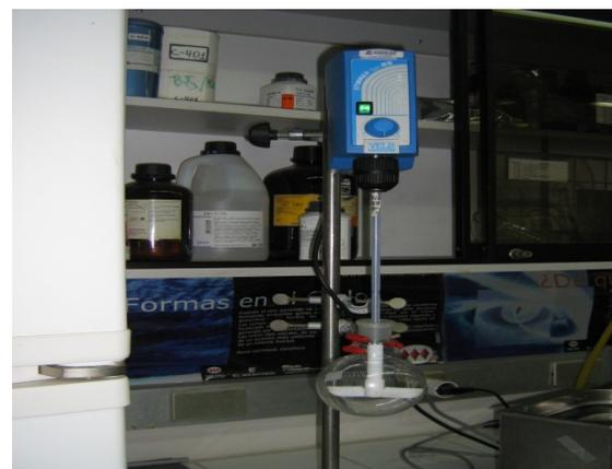
**Figura B-4. Agitador mecánico.**
