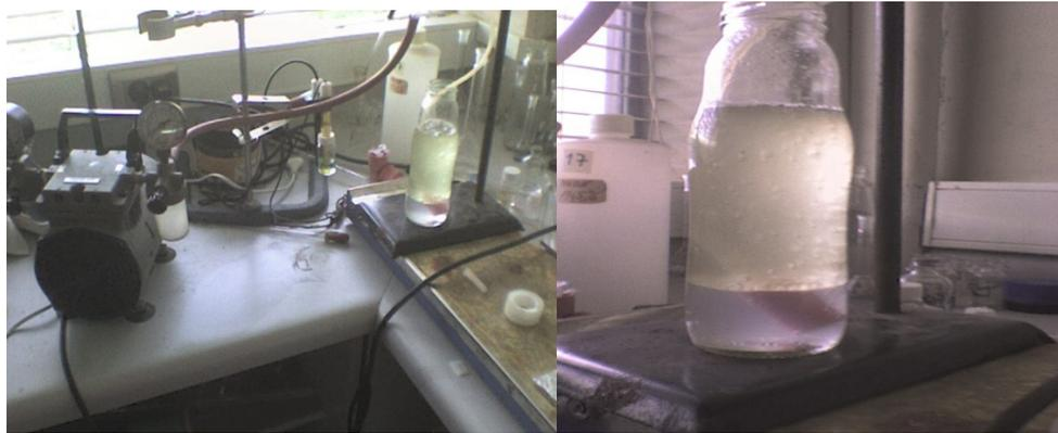
**Figura 7. Lavado Biodiesel**
