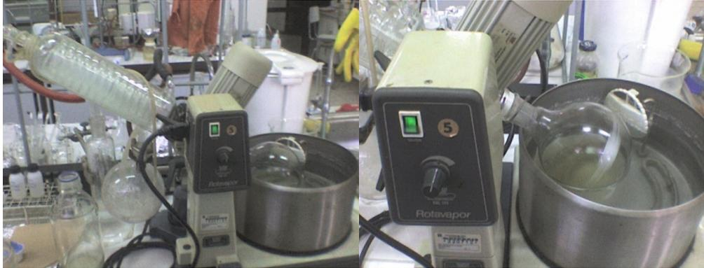
**Figura 8. Secado Biodiesel en rotavapor**
