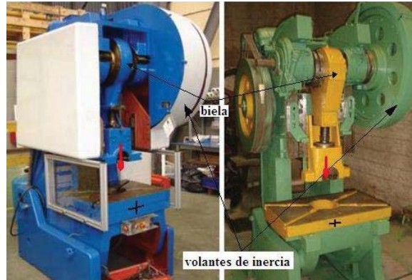
Figura 2-5: Volante de inercia de prensa excéntrica (Fuente: http://www.aulafacil.com )
