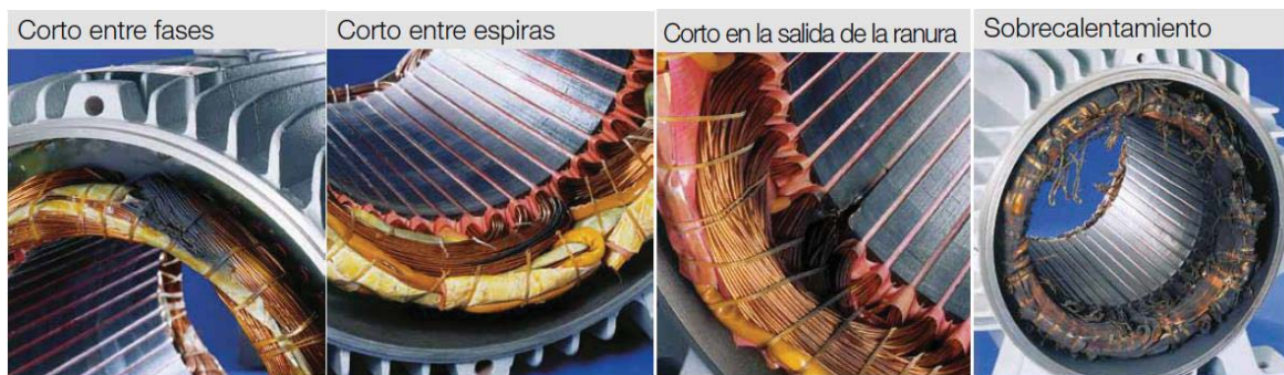
Figura 2-13: Fallas por degradación del aislamiento del bobinado (Fuente: daños en bobinados –WEG)
