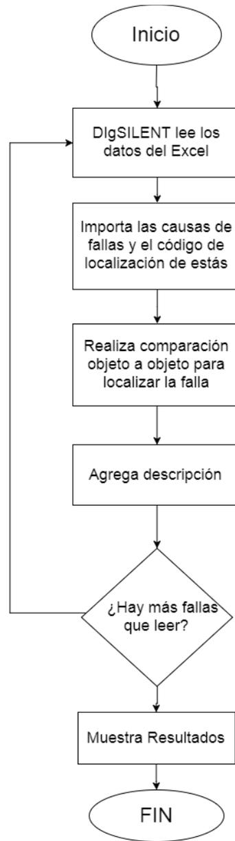
Figura 4-5: Diagrama de flujo del algoritmo utilizado para localización de fallas.
