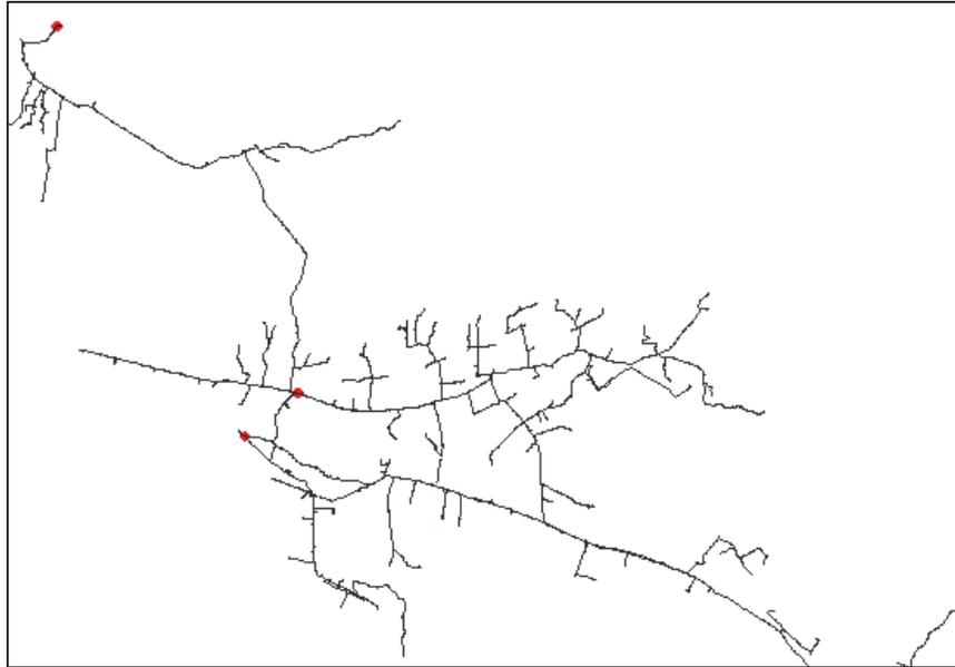
Figura 5-36: Localización de fallas por descargas eléctricas.
