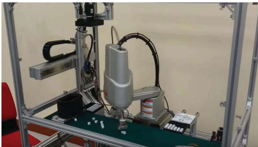
Figura 1-5: Robots RCX340+iVY2 de Yamaha ordenando dados en una bandeja
