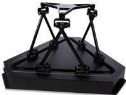
Figura 1-4: Planta Hexapod (Quanser) que ofrece 6 grados de libertad
