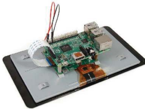
Figura 1-31 Conexión pantalla táctil a Raspberry Pi [13]
