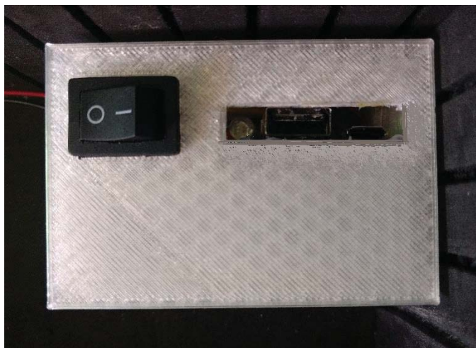
Figura A-2 Banco de baterías, con switch de encendido.
