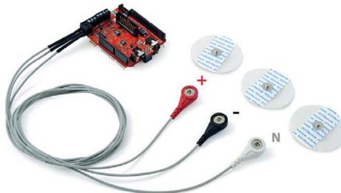
Figura 1-18 Conexión sensor ECG [11]
