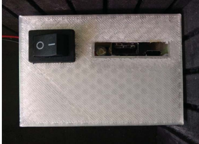
Figura 3-5 Banco de baterías.
