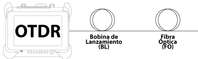
Figura 3-12 Diagrama de conexión entre la bobina de lanzamiento, un rollo de fibra óptica y el OTDR.
