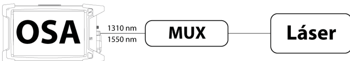
Figura 3-3 Esquema de conexión del multiplexor al OSA.
