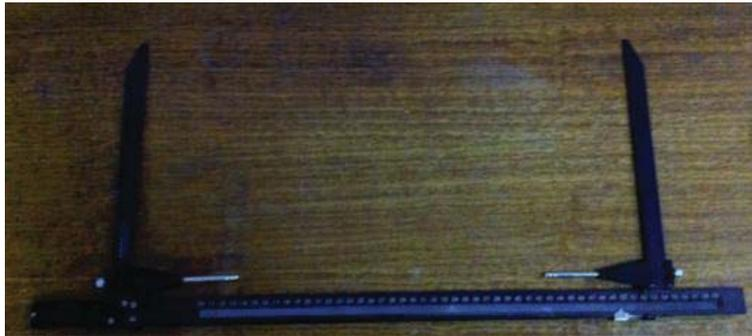
**Figura 62.** Calibre deslizante grande
